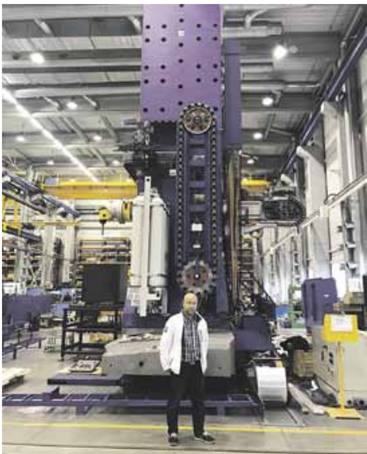
TOS WRD 150 -aarporan vaakasuuntainen liike on 13 metriä ja pystysuuntainen 6 metriä.
